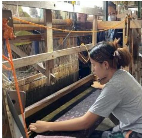
**Gambar 2** Alat Tenun Bukan Mesin
