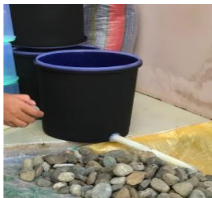
Gambar 1. Lysimeter drainase untuk mengukur koefisien tanaman bawang merah. (Sumber: Dokumentasi Pribadi, 2025).
