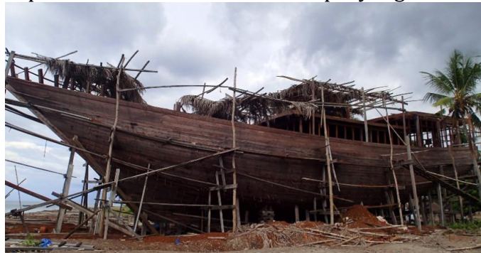
Gambar 1. Kapal Pinisi yang masih dalam proses Pembuatan
