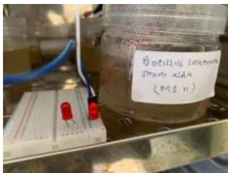
Gambar 1. Pengaplikasian Lampu LED pada MFC dengan Isolat monokultur B. licheniformis strain NA14
