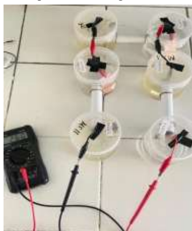
Gambar 2. Pengukuran Voltase pada sistem MFCisolat bakteri B. licheniformis strain NA14 dengan rangkaian seri 3
