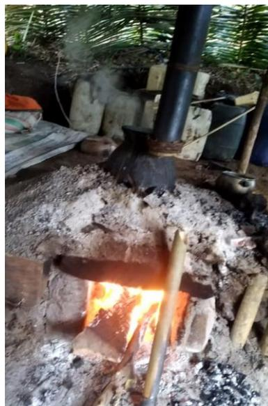
**Gambar 4.** Proses destilasi air nira dengan cara konvensional.
